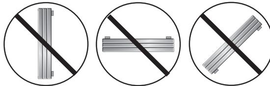
**Pour être installé correctement, le radiateur électrique Runtal de type plinthe doit reposer sur sa base. Aucune autre orientation ne convient.**
